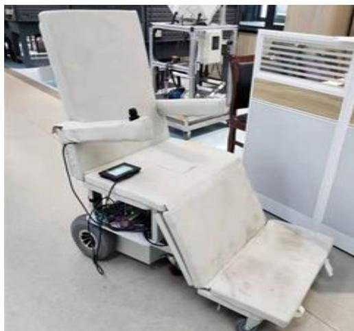
图 8 智能制造及装备技术创研中心研发的床椅一体化机器人样机
